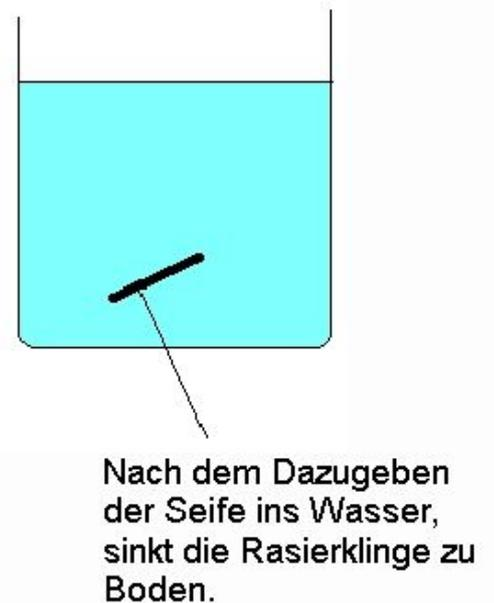
Mit Hilfe eines Löschpapiers legen wir eine Rasierklinge auf eine Wasseroberfläche. Das Löschpapier sinkt ab, die Rasierklinge schwimmt auf dem Wasser.
